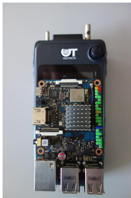
图六 Tinker Board 主板与电脑钥匙对比图
